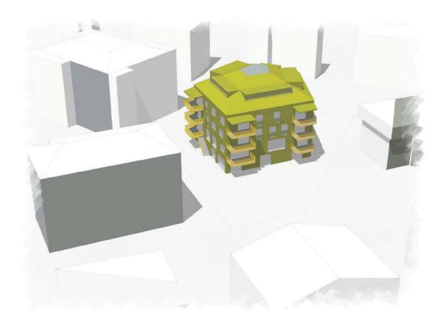
Le bâtiment projeté, à base de plan pentagonal, comprendra quatre niveaux sur rez-de-chaussée, avec combles.
